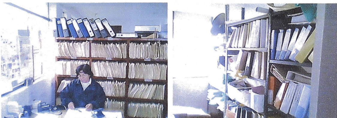
Area de Triage, se observa que los estantes donde se guardan las historias no están fijos y pueden ocasionar daños en caso de sismos.
