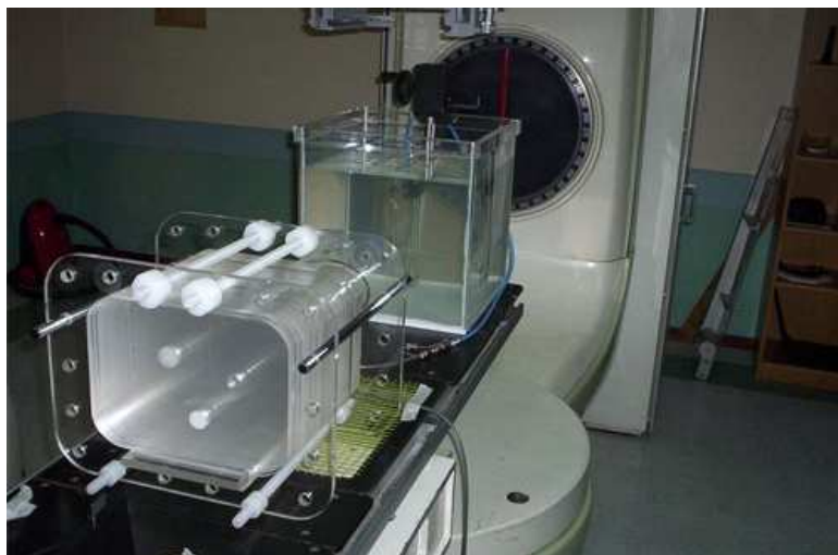
Fig. 71. Fantomas simulado en agua y en un sólido de especiales características
