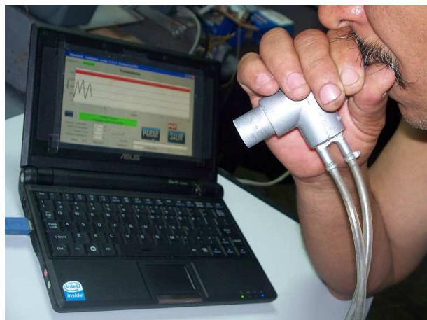
Fig. 42. Sistema de espirometría acoplado a la respiración asistida para radioterapia diseñado por el tesista
