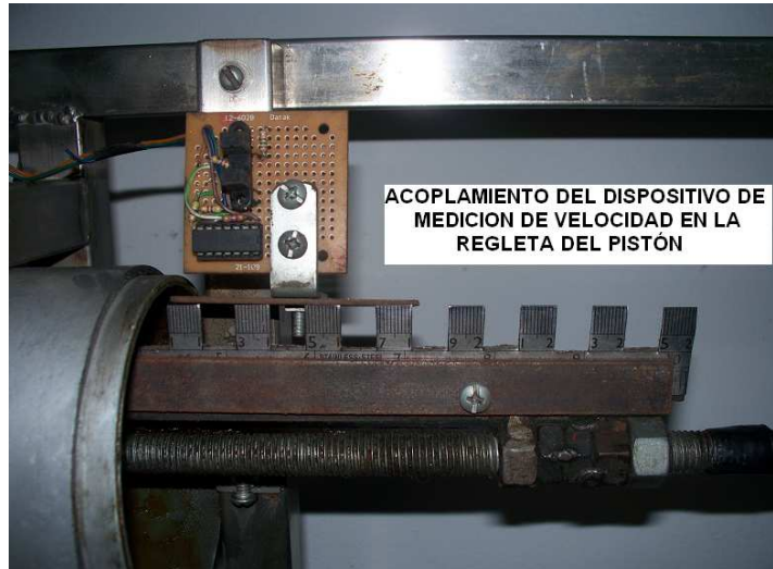
Fig. 24. Este dispositivo permite correlacionar la velocidad del flujo de aire con el volumen instantáneo
