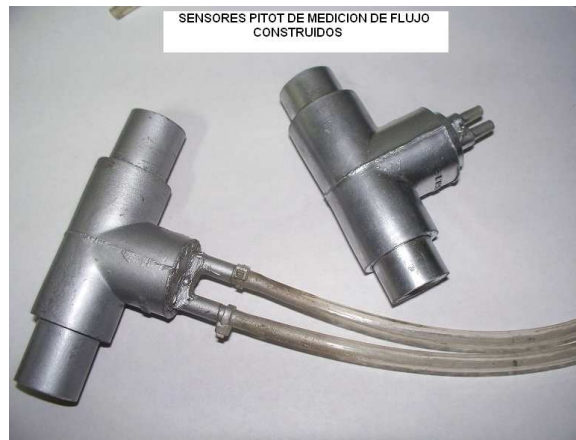
Fig. 21. Apariencia final del tubo “neumotacómetro” desarrollado
