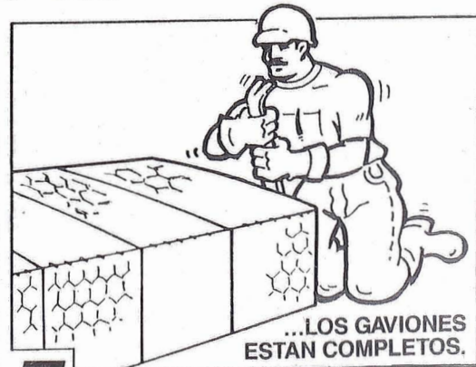
7 Para cerrar las cajas, doble las tapas y amarrelas en los bordes a los paneles verticales siempre con la misma costura. ...LOS GAVIONES ESTÁN COMPLETOS.
