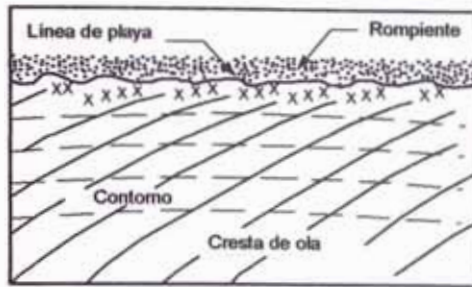
REFRACCIÓN A LO LARGO DE UNA PLAYA RECTA CON CONTORNOS DEL FONDO PARALELOS
