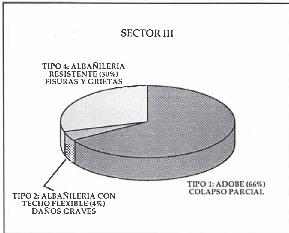
Figura 5.4 Distribución de Clases de Daños en las Edificaciones de los Sectores III y IV - Ciudad de Moquegua.
