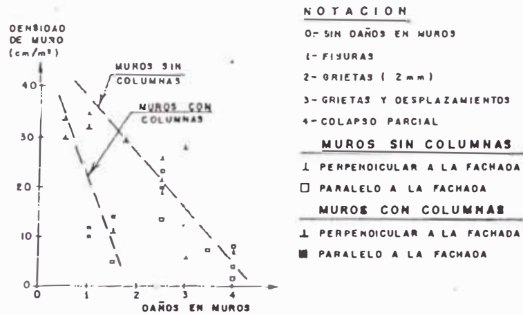
FIGURA N° 6.9 GRAFICO: DAÑOS VS. DENSIDAD DE MUROS
