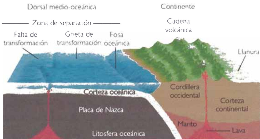
Figura N°2.7. Proceso de subducción.
