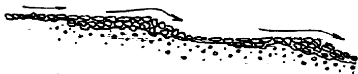
Fig: VI-5. Revestimiento del canal de escorrentía con Azudes extendidos de piedra
