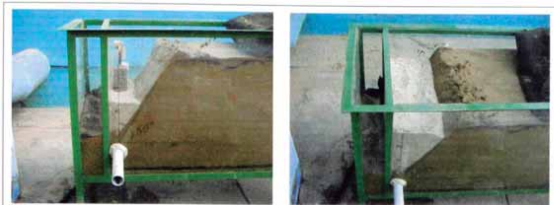
Figura 4.25 Colocación del material de filtro en la cuña
