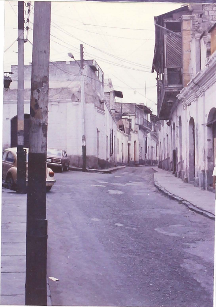
FOTO 9.12 Las instalaciones eléctricas son aéreas en buena parte de la ciudad. Los postes de madera están debilitados, si estos caen en un movimiento sísmico la red de cables cargados de energía ocasionarían grandes problemas las calles.
