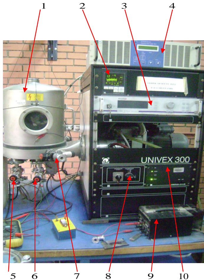
Figura.3.1 Fotografía del equipo DC y RF. Magnetron Sputtering de la Facultad de Ciencias de la UNI utilizado en la elaboración de películas delgadas y nanocompuestos metal dieléctrico de esta tesis.
