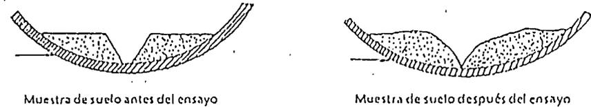
Figura 3. Diagrama ilustrativo del ensayo de límite líquido.
