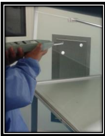
Fig. 32 Ensayo de Medición de Nivel de Ruido
