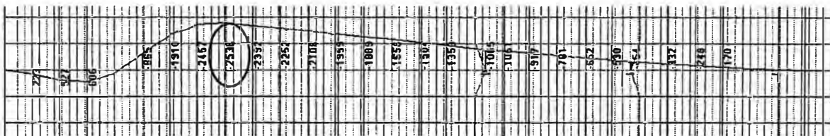
Momentos flectores longitudinales (-) comb. Extreme – H = 2,50m – por una faja de 5m
