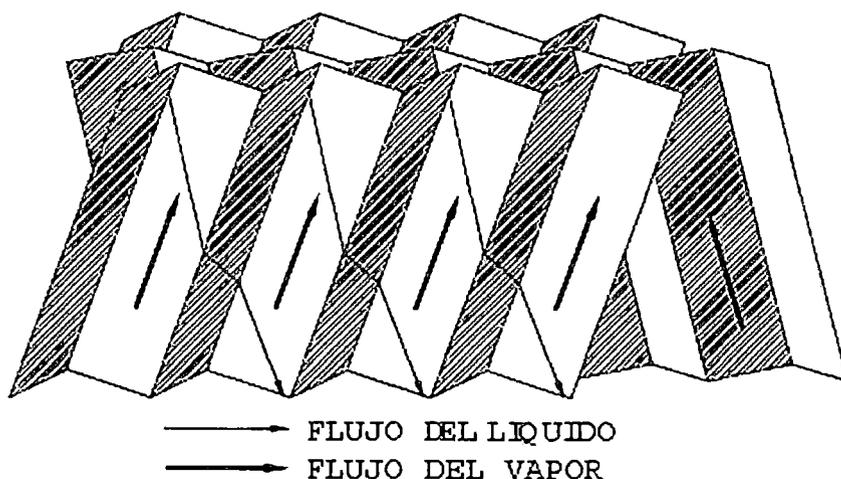
**Figura 2.3 Flujos de la Fase Gaseosa y Líquida [27]**
