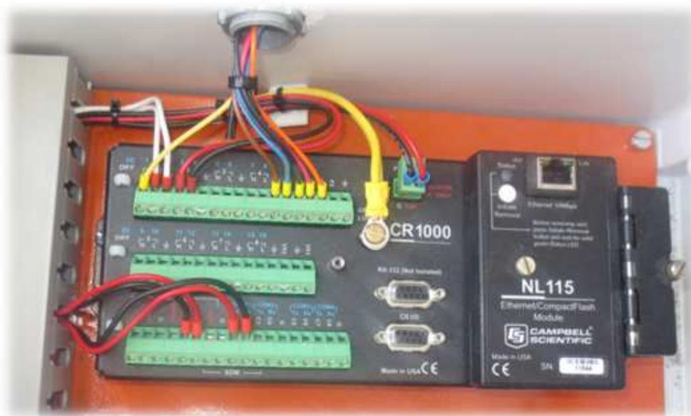
Fotografía 4.- Equipo CR1000 junto a tarjeta de memoria y tarjeta de integración a Ethernet.
