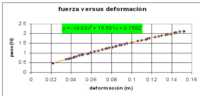
Figura 3.2: Comportamiento del resorte
