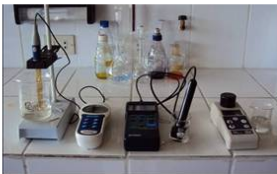
Fig. 26. Equipos de medición de pH, Conductividad y Turbidez.
