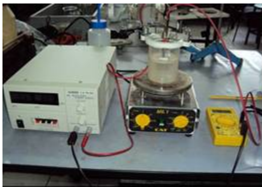
Fig. 24. Proceso de electrocoagulación
