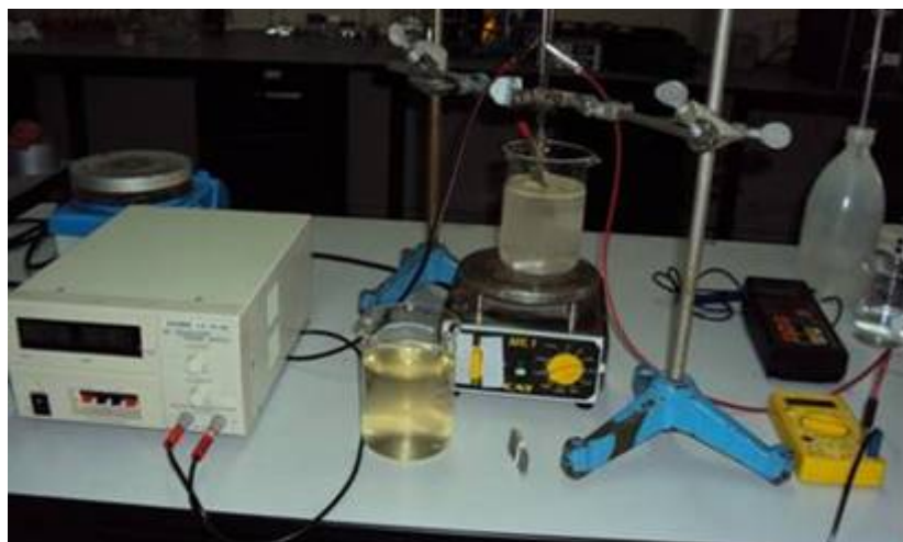
Fig. 32. Prueba de electrocoagulación y equipos utilizados, adelante en un vaso de precipitado se ve la muestra inicial y al lado derecho el par de electrodos.
