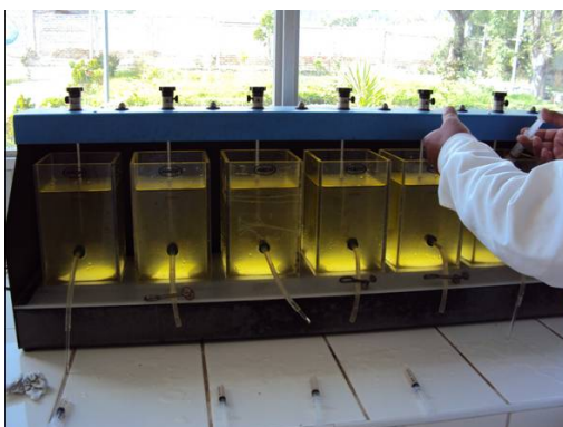
Fig. 27. Aplicación de coagulante a las muestras de agua.
