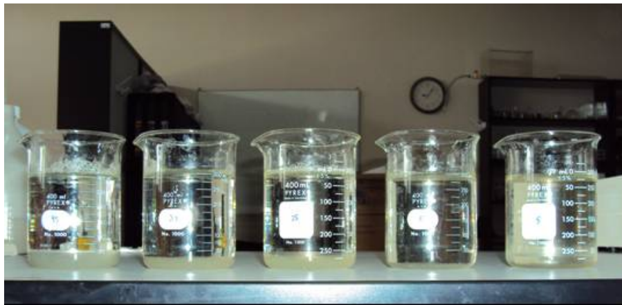
Fig. 35. Precipitados decantados durante la sedimentación.
