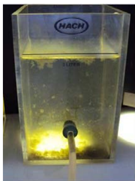
Figura 29. Decantación de flocúlos.
