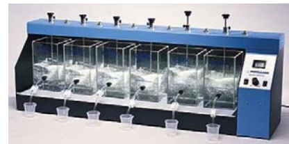
Figura 16. Aparato agitador para la prueba de jarras.
