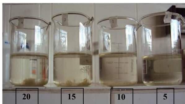
Fig. 22. Sedimentación del precipitado formado
