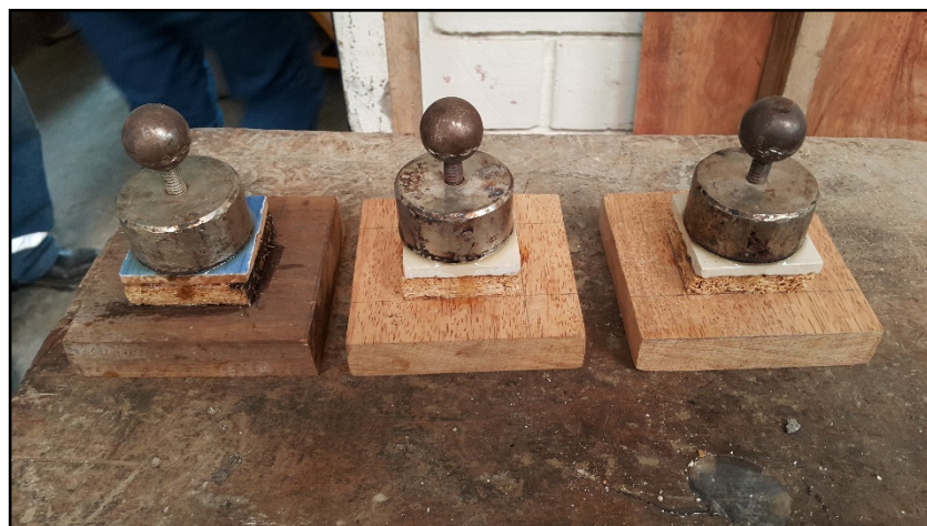
Foto N°3.29 Probetas habilitadas y adheridas al hongo metálico para el ensayo de resistencia al arranque
