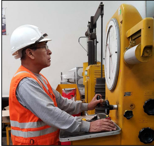
Foto N°3.20 Registro de la carga máxima
