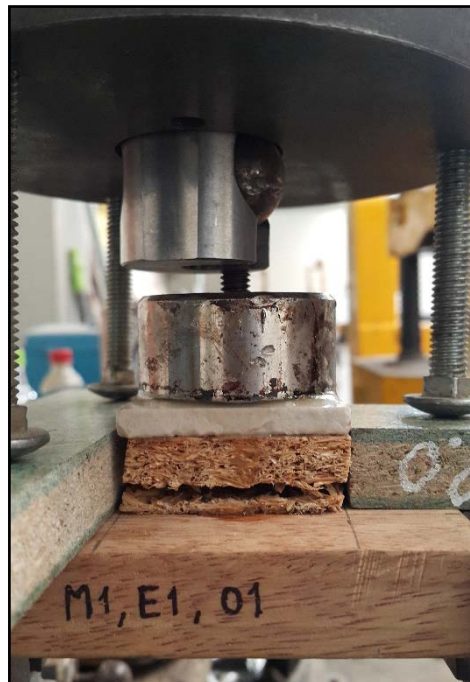
Foto N°3.31 Ensayo de resistencia al arranque de la superficie - Falla en la Probeta
