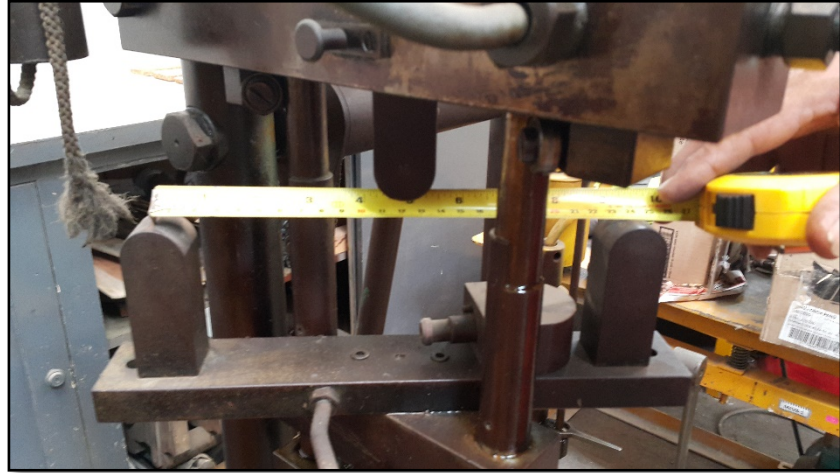
Foto N°3.16 Distancia entre apoyos para probetas E-01
