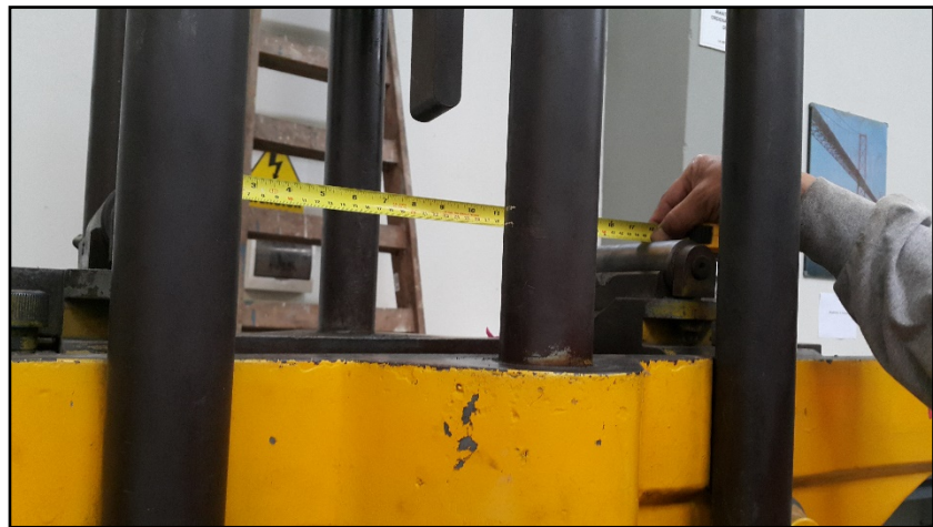
Foto N°3.17 Distancia entre apoyos para probetas E-02
