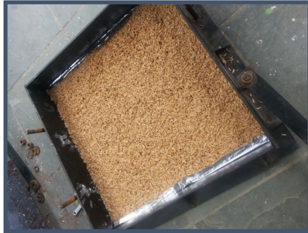
Foto N°3.6 Conformación del colchón en el molde
