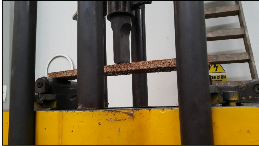
Foto N°3.18 Cabeza de carga cilíndrica en el centro de la probeta
