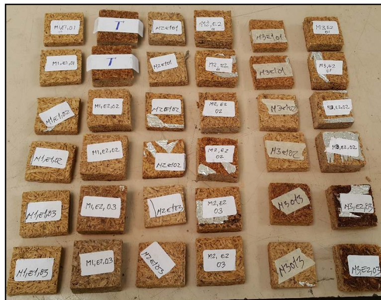
Foto N°3.24 Vista del Grupo de Probetas para el Ensayo de Tracción Perpendicular a las caras.
