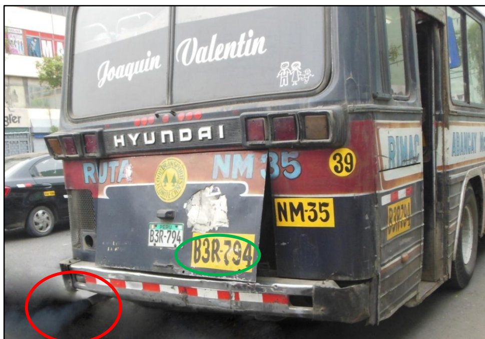
Fotografía 3. Ómnibus obsoleto emitiendo gases contaminantes del tubo de escape en la Avenida Abancay
