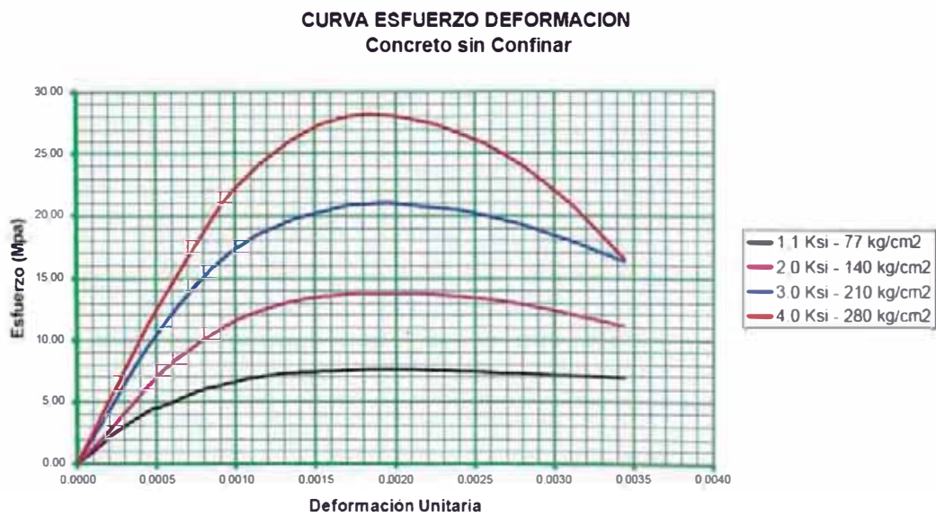
Figura 3-10: Curvas esfuerzo-deformación del material concreto
