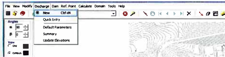
Figura N° 14.- Creación de un punto de descarga (spigot)
