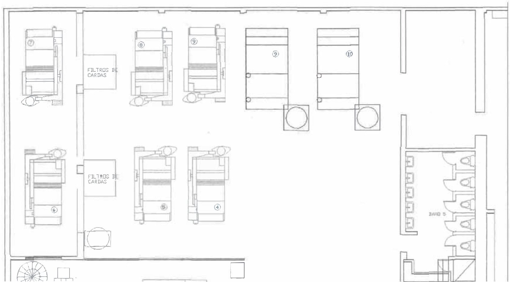
GRAFICO 6.4: Desmontaje de cardas Platt N° 1, 2 y 3. Culminado el montaje de las 2 primeras cardas Trutzschler, se procedió con el desmontaje de las cardas Platt N° 1, 2 y 3.
