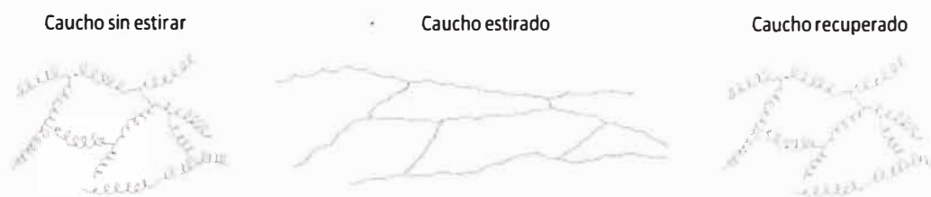
Fig. 2.1 Elasticidad de las moléculas de caucho.
