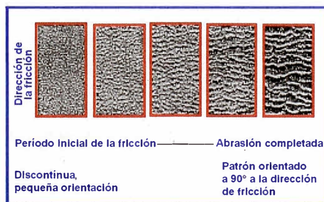
Fig. 2.5 Desarrollo del patrón de abrasión. Fuente: Investigating the mechanism of elastomer abrasion, Liang, 2007
