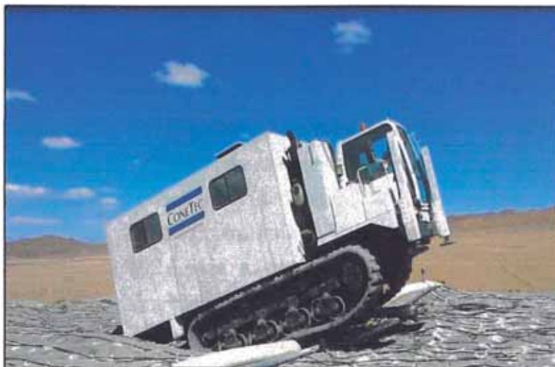
Figura 2. 4: Unidad CPT camión oruga de 20 ton.
