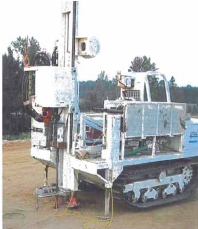
Figura 1.12: Unidad pequeña de perforación-plataforma anclada.
