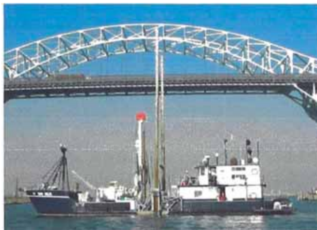
Figura 1.15: Barco Delta Quinn con perforadora.
