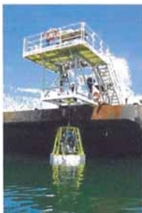
Figura 1.16: Sistema del fondo marino CPT para empujar conos de gran tamaño en aguas muy profundas.
