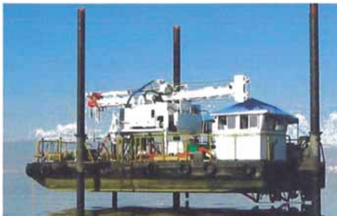
Figura 1.14: Barco Jack-up de tamaño mediano.
