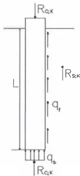
Figura 3.16: Componente de la capacidad de carga de un pilote.
