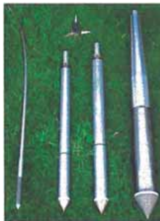
Figura 1.9: Serie de sondas CPT (desde la izquierda: 2cm 2 , 10 cm 2 , 15cm 2 , 40cm 2 )
