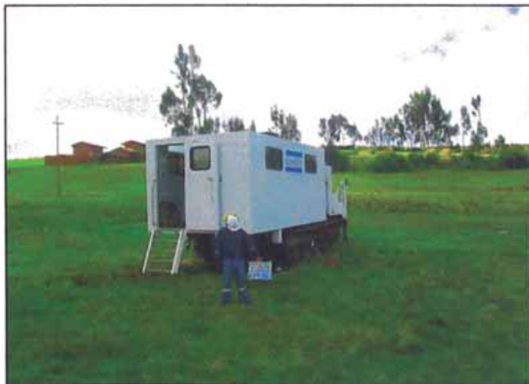
Figura 2. 2: Unidad CPT camión oruga de 20 ton.
