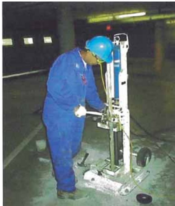
Figura 1.13: Ramset portátil para interiores de edificios CPT o acceso limitado.
