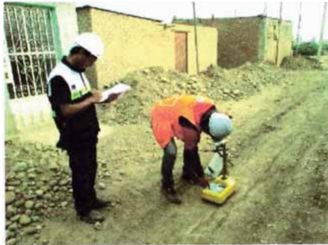
Figura 5 10 – Prueba de compactación con Densímetro Nuclear
