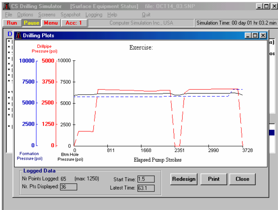
FIGURA N° 12A (POZO CERRADO POR PRESENCIA DE UN INFLUJO)
