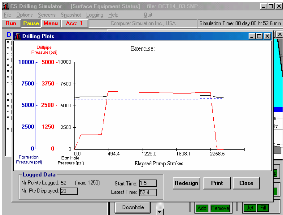
FIGURA Nº 8 (RETOMANDO LA PERFORACIÓN, PERFORANDO A 10206 PIES)
