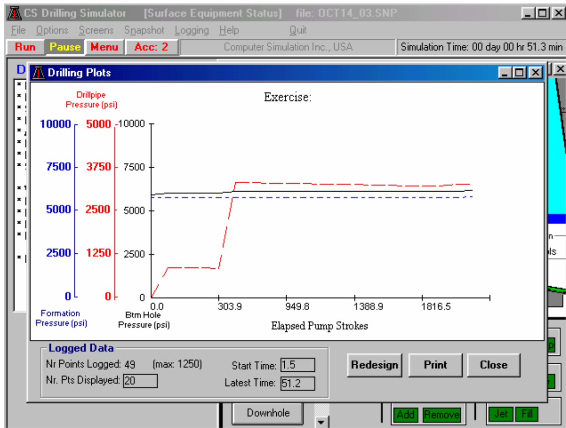
FIGURA N° 7 (CONTROL DE FLUJO, POSIBLE INGRESO DE UN INFLUJO)
