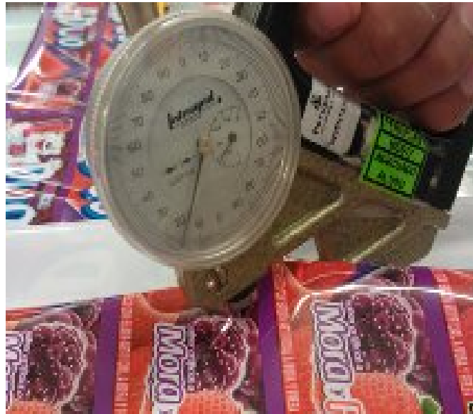
Figura 8: Medición del espesor en una lamina
