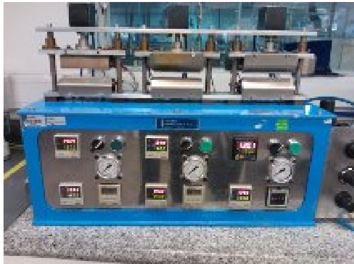
Figura 14: Equipo para la evaluación de resistencia del laminado al calor
