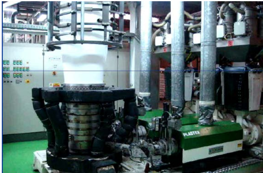
Figura 2: Proceso de obtención de la lamina de polietileno
