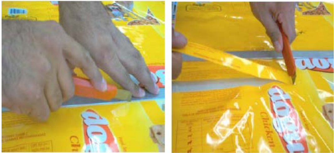
Figura 15: Toma de muestra para la evaluación de fuerza de adhesión
