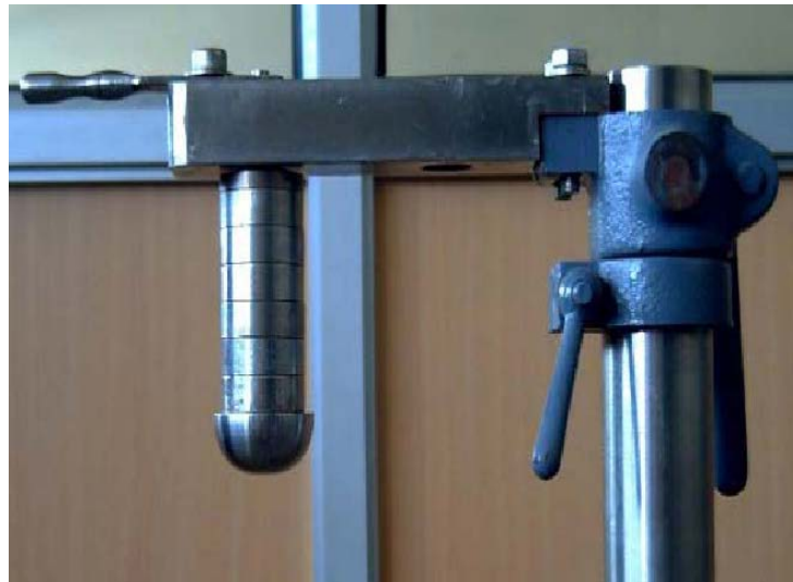
Figura 18: Configuración de dardos y pesas
