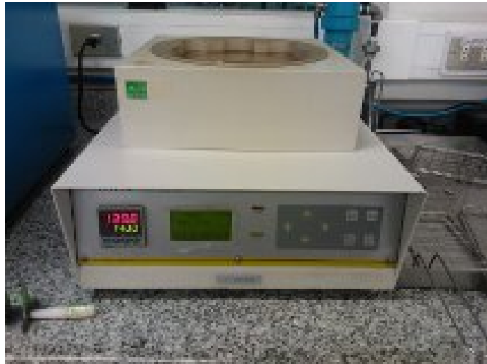
Figura 10: Equipo para la evaluación del termoencogimiento de laminas
