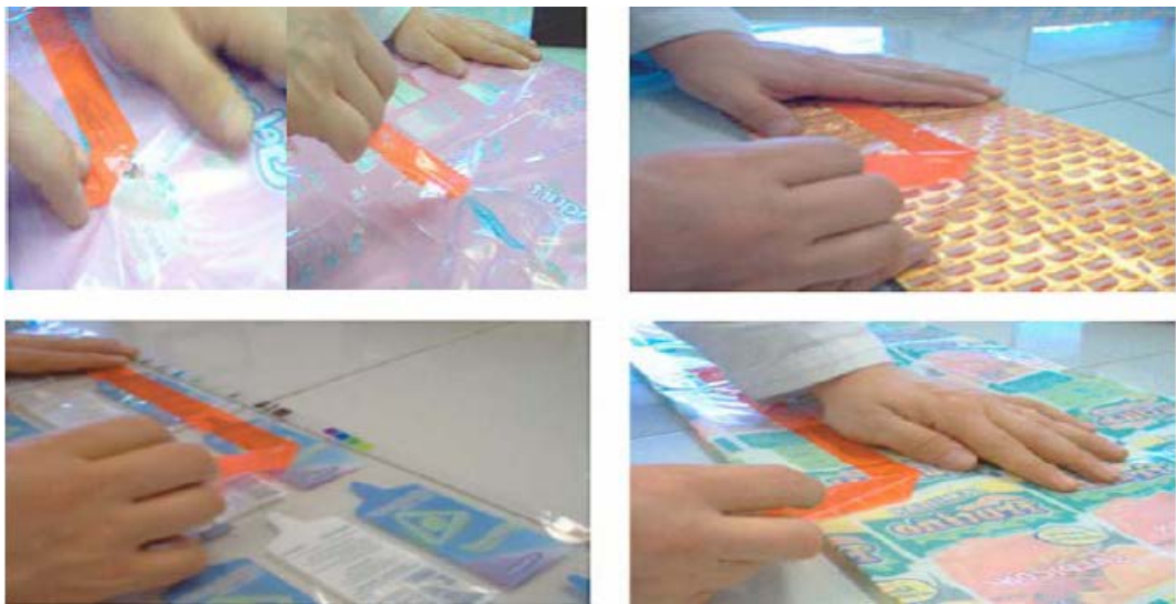
Figura 12: Determinación de la adherencia de tinta
