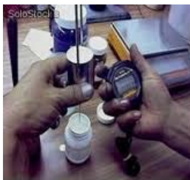
Figura 19: Medición de la viscosidad usando copa zahn.
