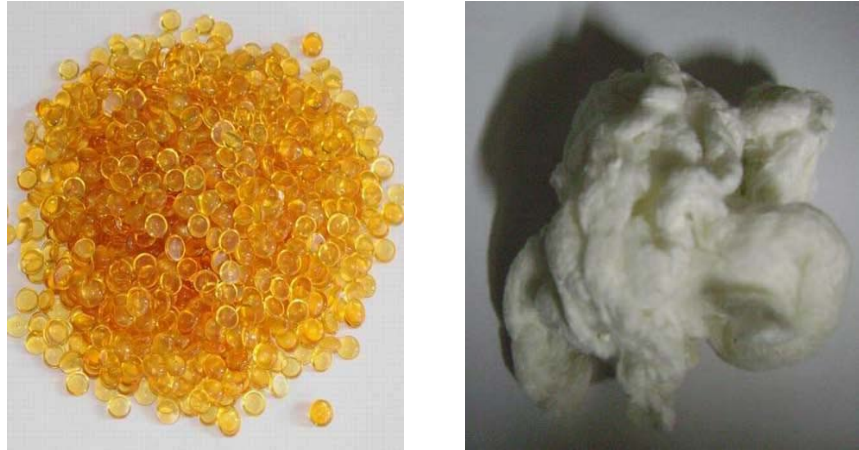
Figura 12: Resinas usadas en tinta Superprint: Poliamida (principal) y Nitrato de celulosa (co – resina).
