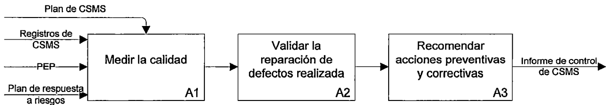
Figura 4.26. Proceso de control de CSMS
