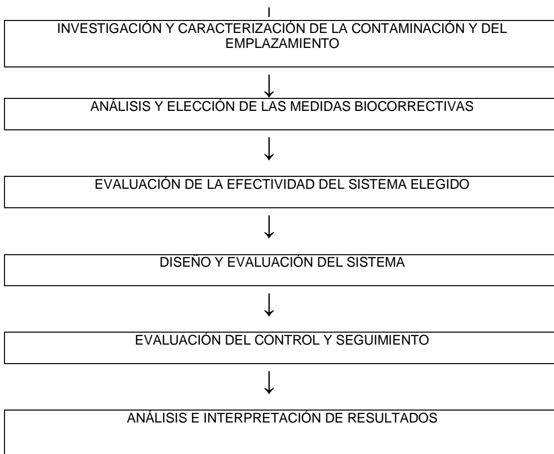
Diagrama: Esquema de diseño y aplicación de los sistemas de biotratamiento
