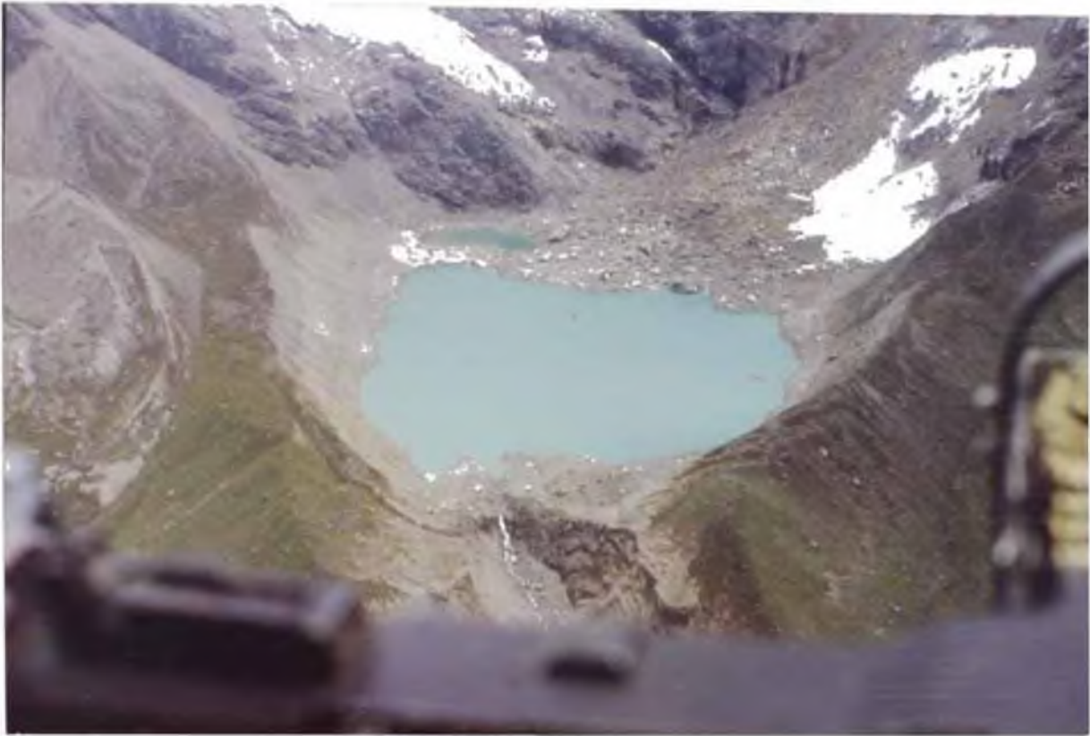
FOTO Nº 9.5 y 9.6: Vista aérea del vaso de la laguna Chuspicocha, el pie del talud de la avalancha, el dique morrénico frontal erosionado por el desbordamiento. la morfología de la laguna a cambiado podemos apreciar el nivel que descendió el espejo de la laguna y huellas del oleaje ocasionadas por la avalancha. (ENE -91)
