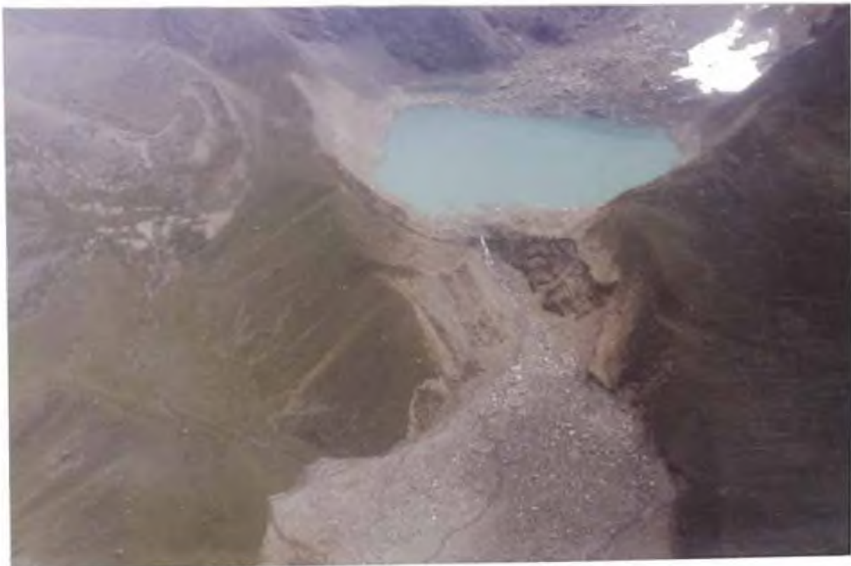
FOTO Nº 9.5 y 9.6: Vista aérea del vaso de la laguna Chuspicocha, el pie del talud de la avalancha, el dique morrénico frontal erosionado por el desbordamiento. la morfología de la laguna a cambiado podemos apreciar el nivel que descendió el espejo de la laguna y huellas del oleaje ocasionadas por la avalancha. (ENE -91)
