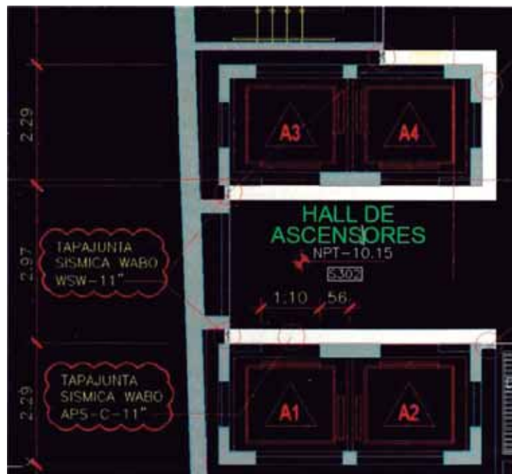
Figura N°15.- Aislamiento de ascensores
