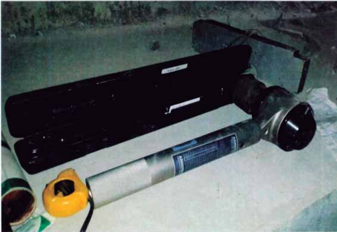
Figura N°58.- Torquímetro y tope para la aplicación sobre pernos de aisladores
