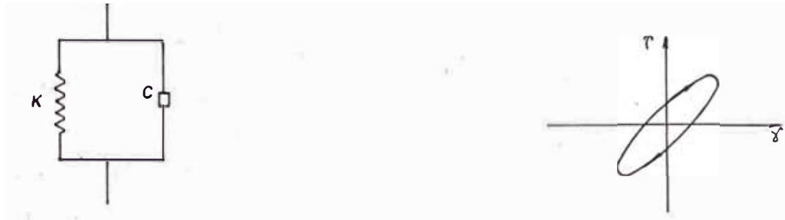
b) Curva típica real de esfuerzo-deformación.
