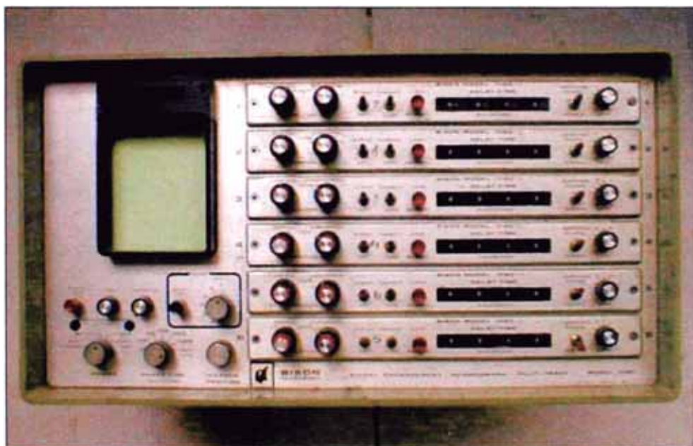
FIG. 25: Acondicionador de Señales BISON.
