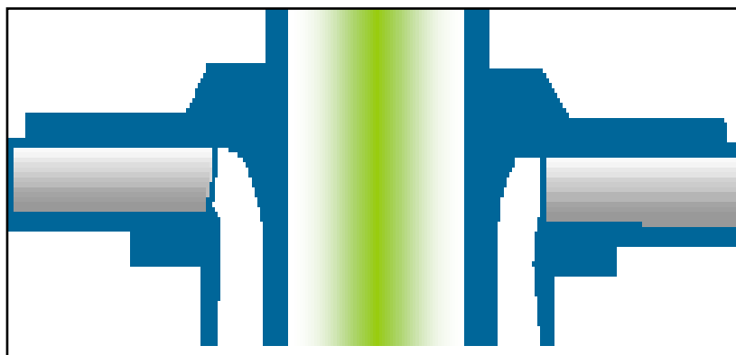
Figura de Flujo Radial: El patrón de flujo es generalmente perpendicular (radial) con respecto al eje de la bomba.
