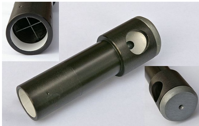
FIGURA 3.17: Colimador Celestron empleado en la primera colimación del tubo óptico. Imagen de referencia descargada de https://en.wikipedia.org/wiki/Cheshire_eyepiece
