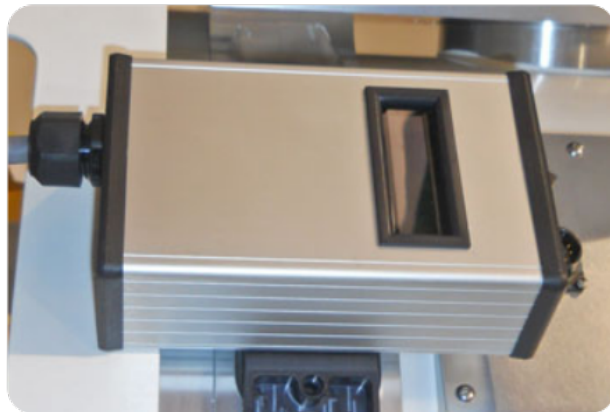
FIGURA 2.9: Telescope Interface Module (TIM) . Controlador de accesorios del tubo óptico. Imagen descargada de la página web del fabricante http://www.rcopticalsystems.com/accessories/tim.html .
