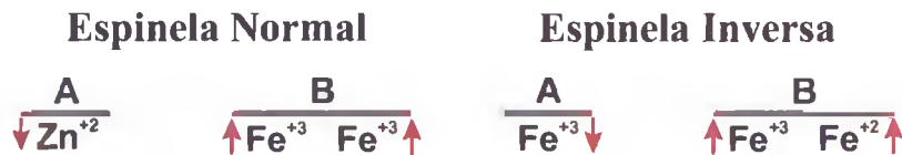
Figura 1.2: Distribución catiónica en la estructura espinela normal (como ejemplo: \text{ZnFe}_2\text{O}_4 ) y espinela inversa (como ejemplo: la magnetita, \text{Fe}_3\text{O}_4 ). En la espinela normal, el catión \text{Zn}^{2+} ocupa el sitio tetraédrico (A) y el ión \text{Fe}^{3+} ocupa el sitio octaédrico (B); en la espinela inversa, el catión \text{Fe}^{3+} ocupa el sitio tetraédrico (A) y los iones \text{Fe}^{2+} y \text{Fe}^{3+} ocupan el sitio octaédrico (B).
