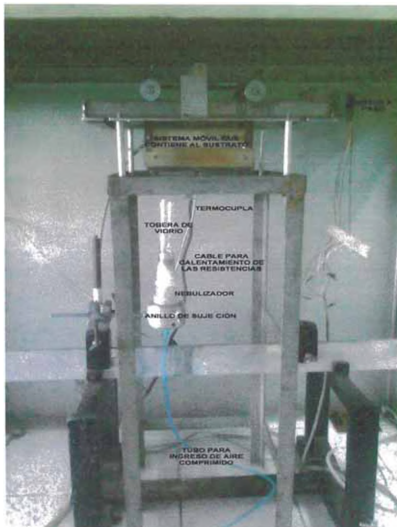
Figura 12. Sistema de rociado pirolítico para la fabricación de películas delgadas.
