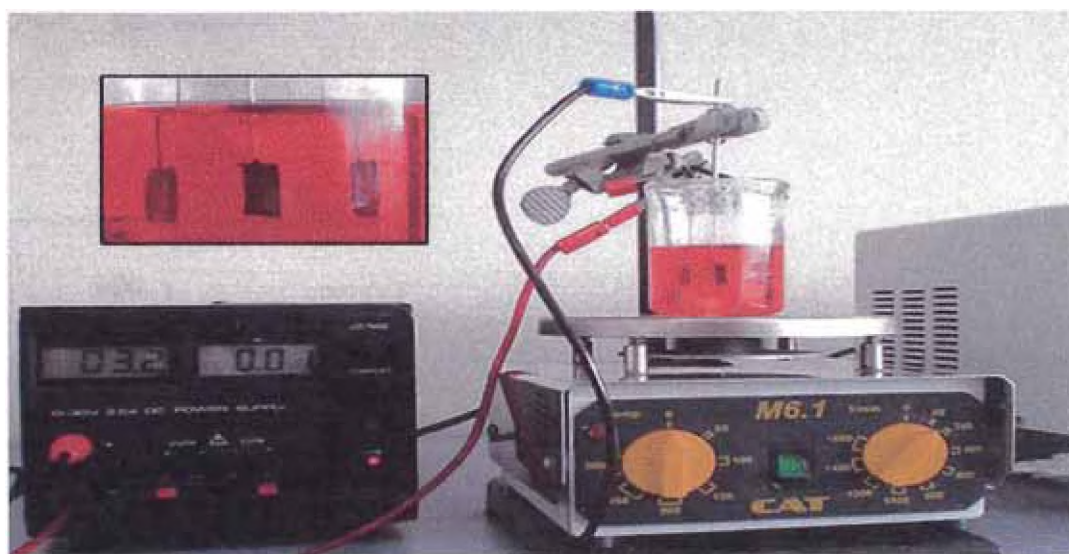
Figura 20. Disposición del equipo para llevar a cabo la oxidación electroquímica
