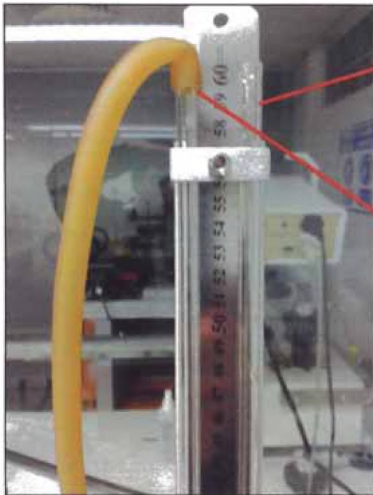
Figura 3.12 Colocación de los tubos de vidrio del patrón de columna de agua.
