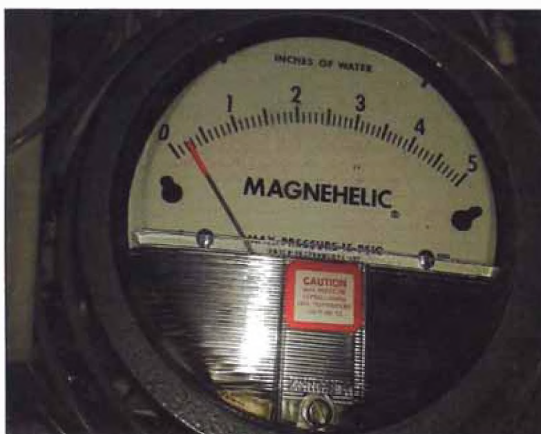
Figura 3.8 Modelo de manómetro diferencial que será calibrado con el patrón de columna líquida.
