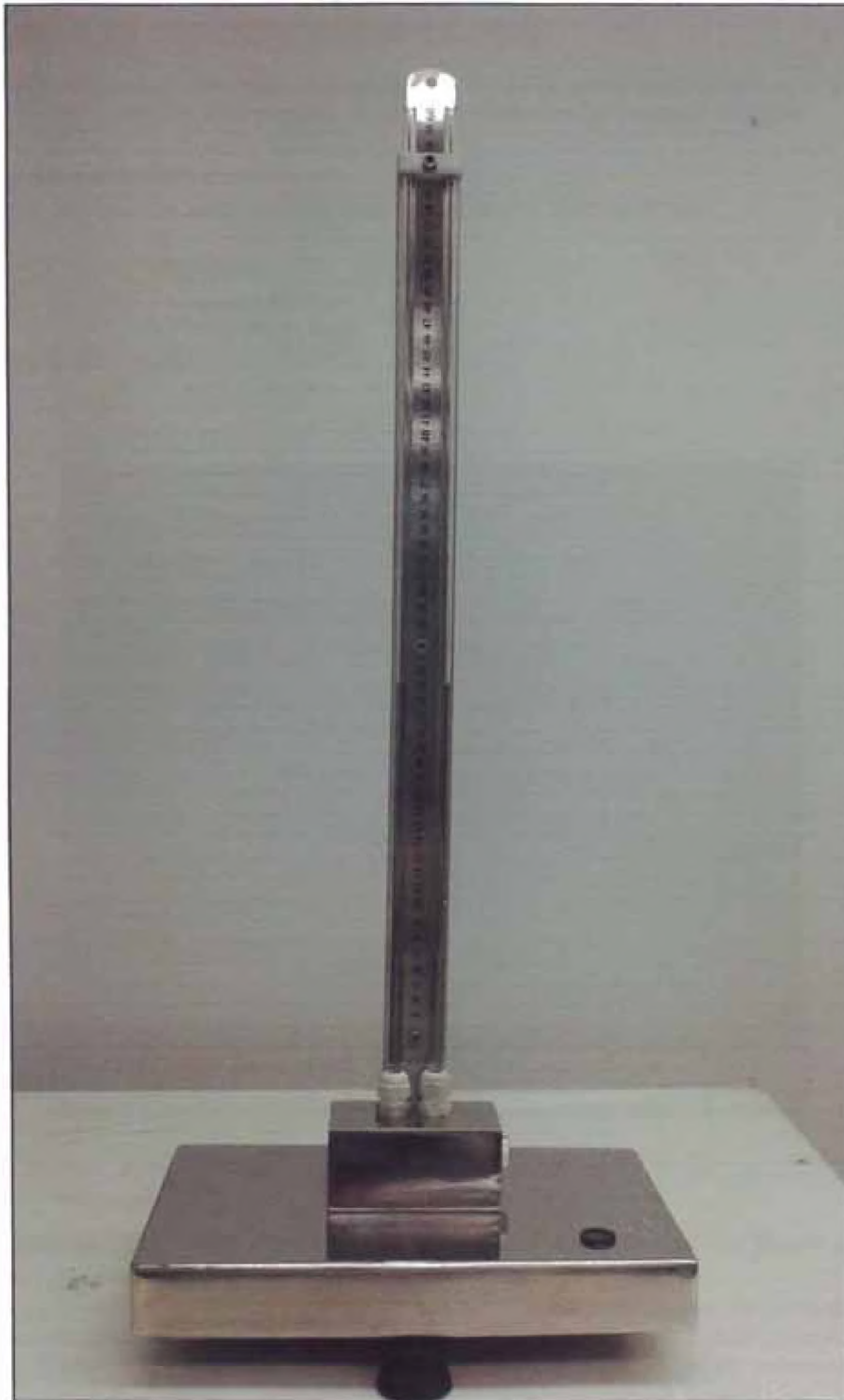
Figura 3.7 Diseño del manómetro patrón de columna líquida de agua.
