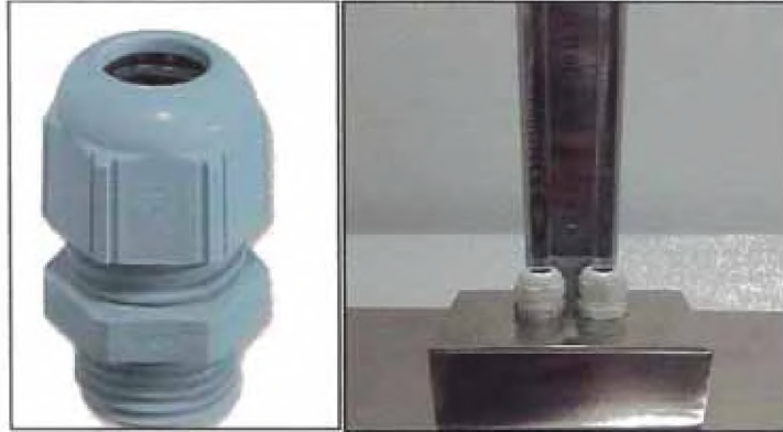
Figura 3.6 En el lado izquierdo se muestra una prensaestopa y en el derecho se observa como van enroscadas al bloque y sujetando a los tubos de vidrio.
