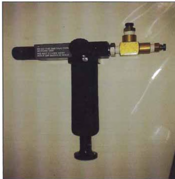
Figura 3.11 Bomba neumática o generador de presión. Posee un conector con dos salidas, una estará conectada al patrón y la otra al manómetro diferencial.
