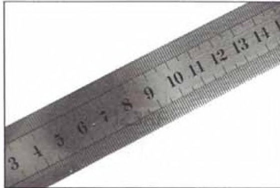
Figura 3.4 Regla de acero que servirá como escala para la medición de la columna de agua.
