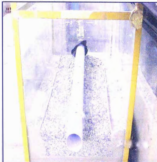
Figura N° A1.5.- Se observa como es colocada la tubería junto con el material envolvente teniendo en cuenta la pendiente.
