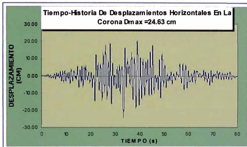
**Fig.6.19:** Tiempo–Historia de los desplazamientos horizontales calculados en la corona, para el sismo de Moquegua – Perú 23/06/2001.
