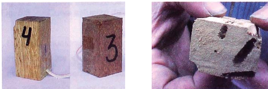
Foto 5.44 Muestras extraídas de madera de la estructura. Izquierda: Especímenes 3 y 4. Derecha: espécimen de madera con presencia de polilla.
