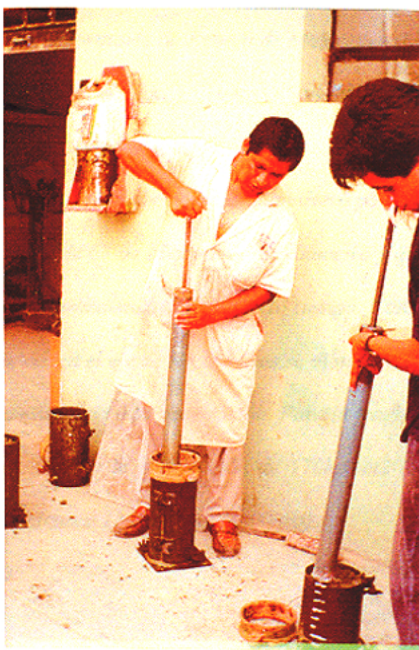
Foto 5 COMPACTACIÓN DE LA ÚLTIMA CAPA
