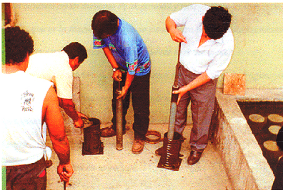
Foto 4 COMPACTACIÓN DE PROBETA
