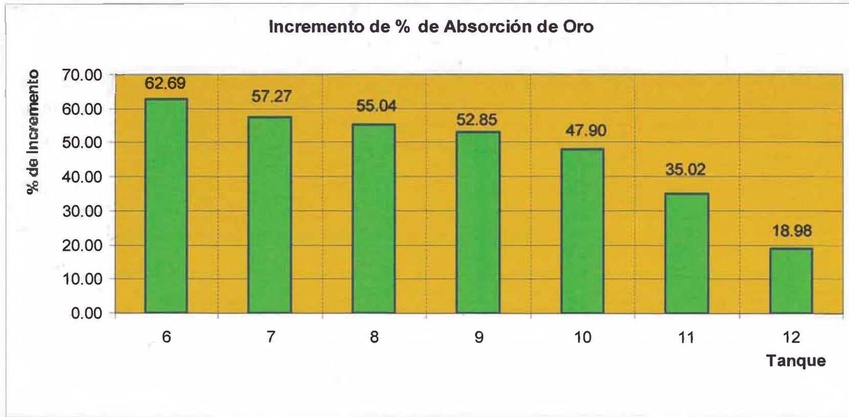
Figura N° 50.- Incremento de la eficiencia de adsorción del carbón activado usando antincrustante
