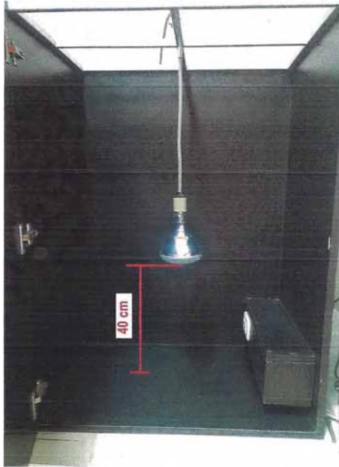
Figura 16: Imagen de la cámara donde se realizaron los procesos de fotocatalisis.
