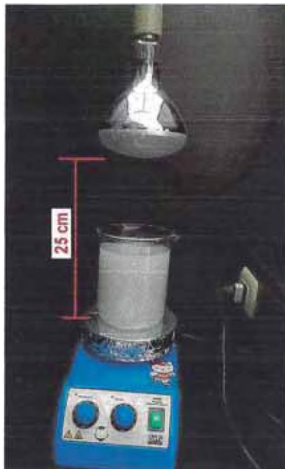
Figura 20: Disposición del vaso de precipitado respecto a la lámpara Ultra-Vitalux.
