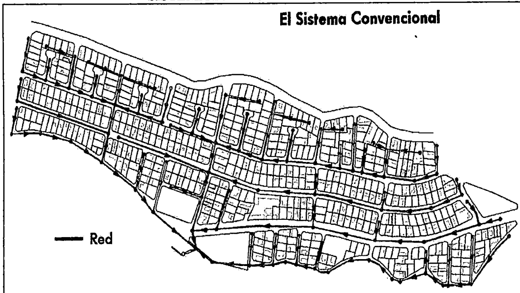
GRAFICO 2.1 TENDIDO DE TUBERÍA DE LA RED PRINCIPAL PARA EL SISTEMA DE ALCANTARILLADO CONVENCIONAL
