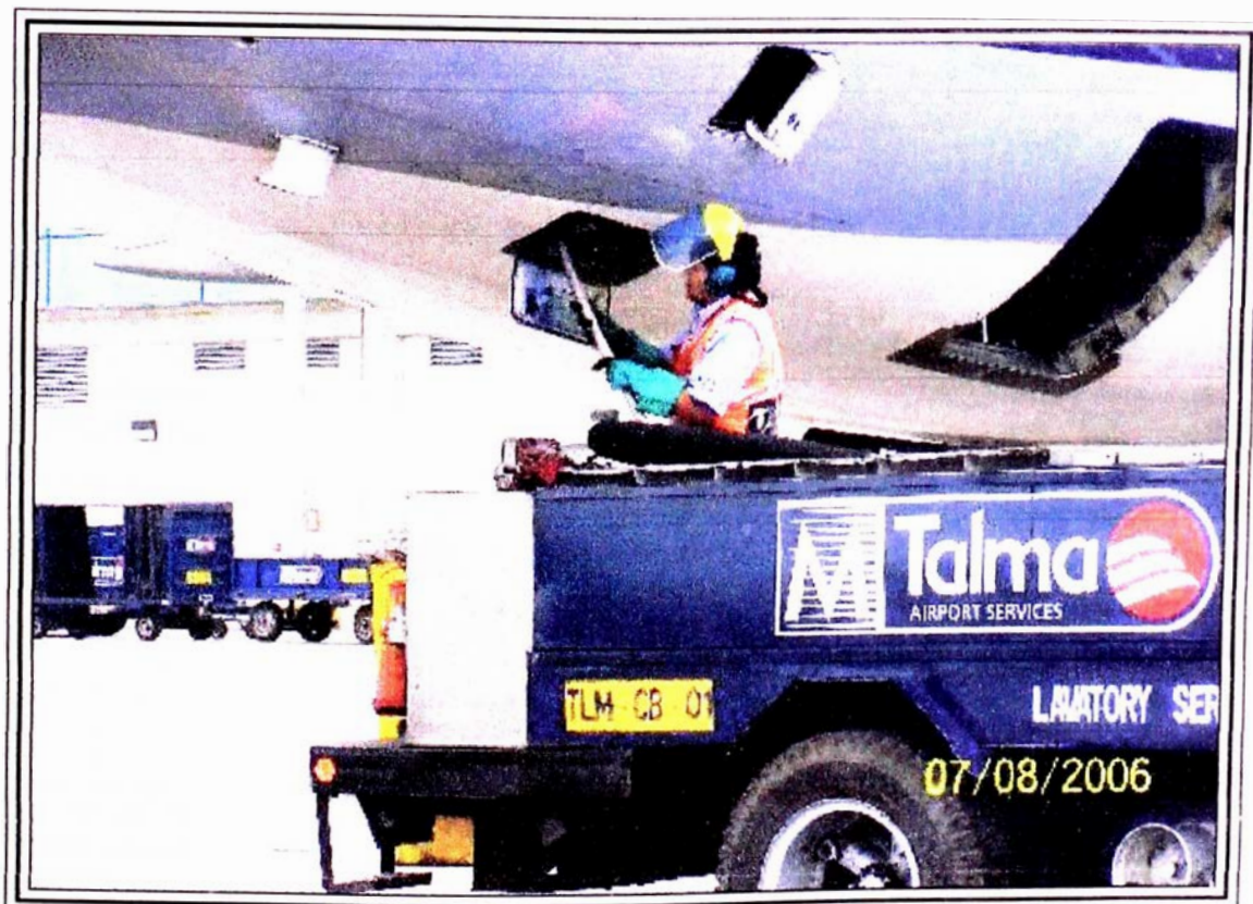
Foto 10 Descarga del agua residual de los aviones.
