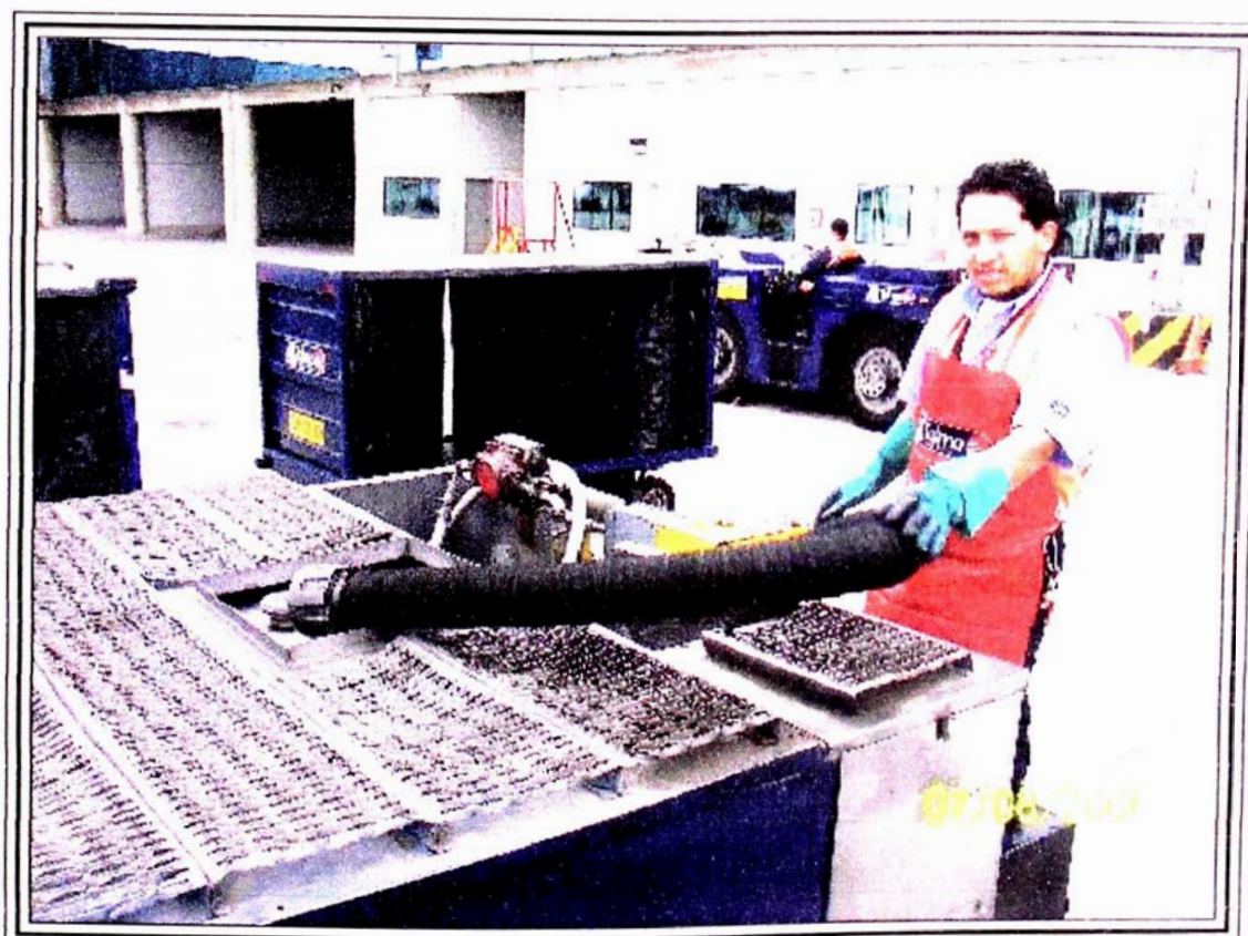
Foto 08 Preparación de Manguera para conexión hermética a avión, descarga "Blue Water"
