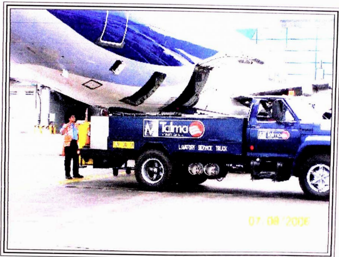
Foto 09 Manguera conectada y vehículo en posición para descarga
