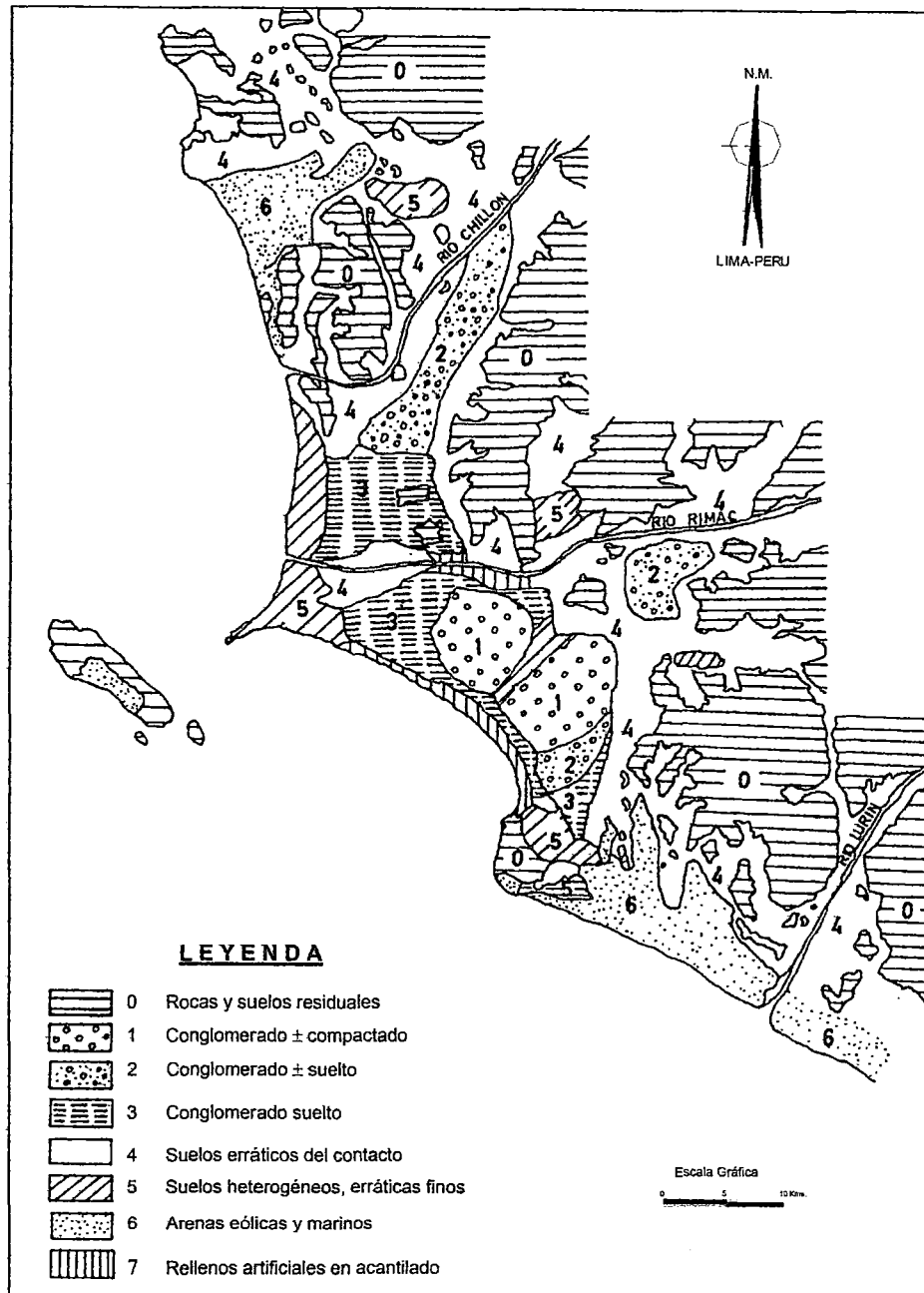
Figura G2-07. Mapa de las condiciones de Mecánica de Suelo de la ciudad de Lima. Fuente: Martínez Vargas, 1986.
