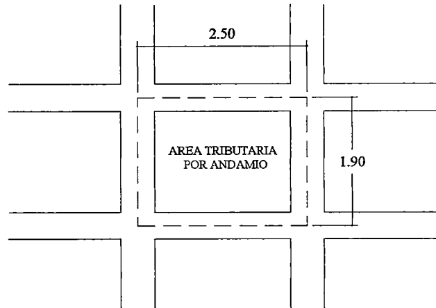
Figura N°5-22 Área tributaria por andamio metálico
